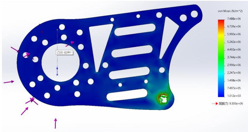
图 3-21 固定电机的摇臂
